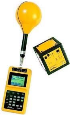
Fig. 7-7: Elektrische und magnetische Feldmessgeräte (Quelle: Narda-STS)
