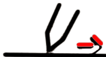
Abb. 70: Die beim Streichen, Reiben und Rippen ausgeführte Bewegung. (Schwarzer Pfeil = Bewegungsrichtung; Roter Pfeil = Druckrichtung).
