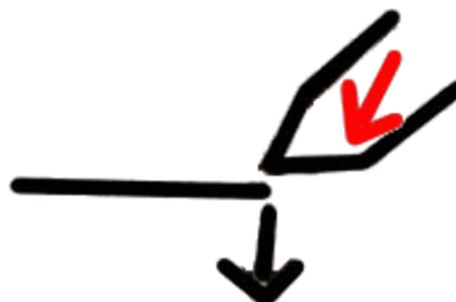
Abb. 79: Die beim Drücken ausgeführte Bewegung. (Schwarzer Pfeil = Bewegungsrichtung; Roter Pfeil = Druckrichtung).
