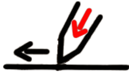
Abb. 71: Die beim Schaben ausgeführte Bewegung. (Schwarzer Pfeil = Bewegungsrichtung; Roter Pfeil = Druckrichtung).
