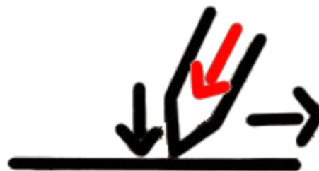
Abb. 74: Die beim Ritzen ausgeführte Bewegung. (Schwarzer Pfeil = Bewegungsrichtung; Roter Pfeil = Druckrichtung).
