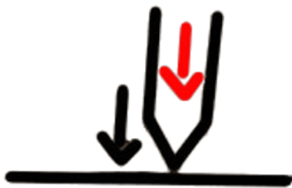
Abb. 75: Die beim Stechen ausgeführte Bewegung. (Schwarzer Pfeil = Bewegungsrichtung; Roter Pfeil = Druckrichtung).
