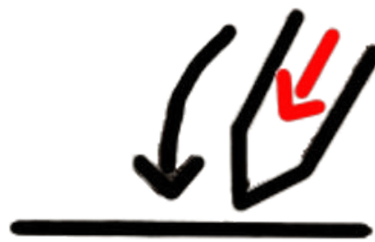
Abb. 76: Die beim Schlagen ausgeführte Bewegung. (Schwarzer Pfeil = Bewegungsrichtung; Roter Pfeil = Druckrichtung).
