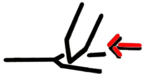
Abb. 72: Die beim Spalten ausgeführte Bewegung. (Schwarzer Pfeil = Bewegungsrichtung; Roter Pfeil = Druckrichtung).
