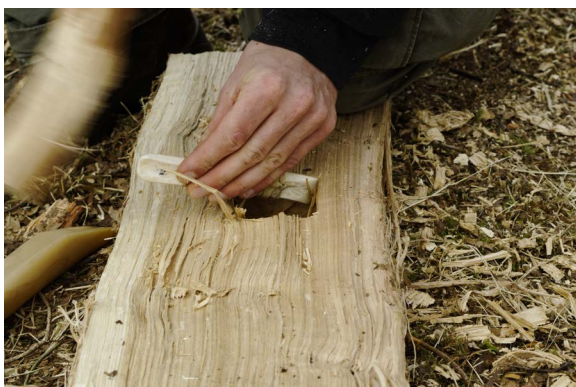
Abb. 29: Verschiedene Werkzeuge bei der Verwendung von Holz. Links ein Beitel, der aus einem Knochenspan hergestellt wurde. Der Schlag des Klöpfels erfolgt direkt auf die Basis. Das Werkzeug hat schon viele Arbeitsstunden hinter sich gebracht, arbeitet aber immer noch vorzüglich. Rechts Nahaufnahme, wie der Knochenbeitel einen Teil des Holzes für eine Verkämmung entfernt.
