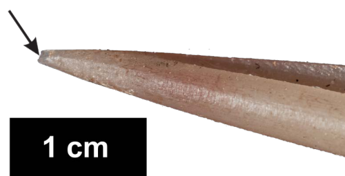
Abb. 66: Bruch durch Drehbewegung. Dabei bricht der Arbeitsbereich plattig in Drehrichtung aus. Oftmals entsteht eine „Bohrspitze“.
