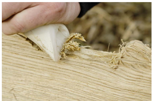
Abb. 29: Verschiedene Werkzeuge bei der Verwendung von Holz. Links ein Beitel, der aus einem Knochenspan hergestellt wurde. Der Schlag des Klöpfels erfolgt direkt auf die Basis. Das Werkzeug hat schon viele Arbeitsstunden hinter sich gebracht, arbeitet aber immer noch vorzüglich. Rechts Nahaufnahme, wie der Knochenbeitel einen Teil des Holzes für eine Verkämmung entfernt.
