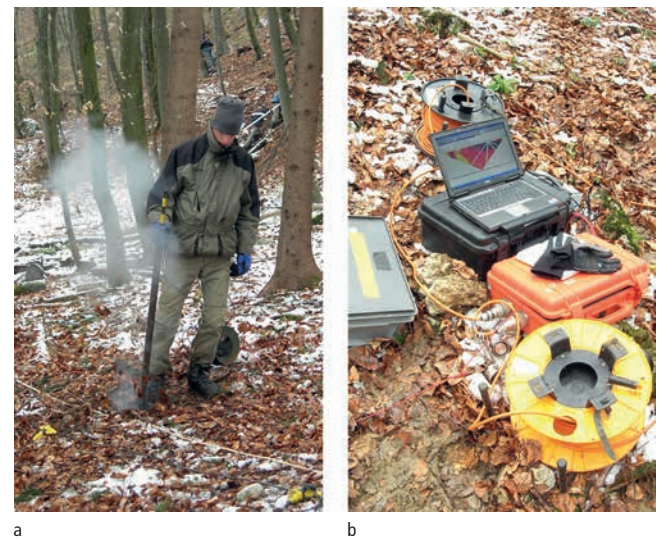
Abb. 72. Geophysikalische Messungen der ETH Zürich im Rahmen der Joint Master Field-Kurse 2008–2010. a: Seismikmessung mit Sprengpatrone zur Erzeugung des Quellsignals; b: Ausrüstung für die Geoelektrikmessung.
