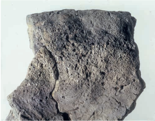
Abb. 418. Meilen-Schellen. Gusstiegefragment mit starker, bimssteinartiger Tonaufschäumung. Sie belegt zweifelsfrei, dass die verwendete Tonmasse den hohen Temperaturen beim Aufschmelzprozess nicht standhielt.
